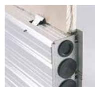
Le système est étudié pour être encastré dans des plaques de plâtre d'épaisseur prévues entre 13 et 26 mm. La fixation par arrière est réalisée par un évier venant de lui-même se positionner derrière la plaque de plâtre par simple vissage.
